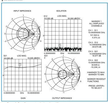
Figure 2. Four S-parameter display of amplifier parameters
